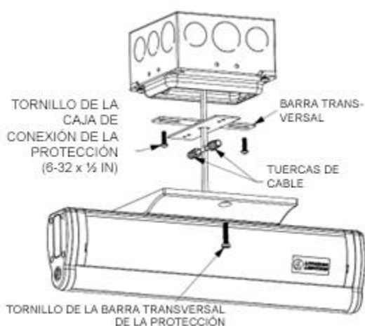
CONFIGURACIÓN 1: MONTAJE DE TECHO CON BARRA TRANSVERSAL (SI LOS ORIFICIOS DE LA CAJA DE CONEXIÓN NO SE ALINEAN CON LOS ORIFICIOS DE LA PROTECCIÓN)
