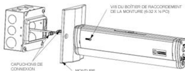
CONFIGURATION 2 : MONTAGE LATÉRAL SANS BARRE TRANSVERSALE (SI LES TROUS DU BOÎTIER DE RACCORDEMENT SONT ALIGNÉS AVEC LES TROUS DE LA MONTURE)
